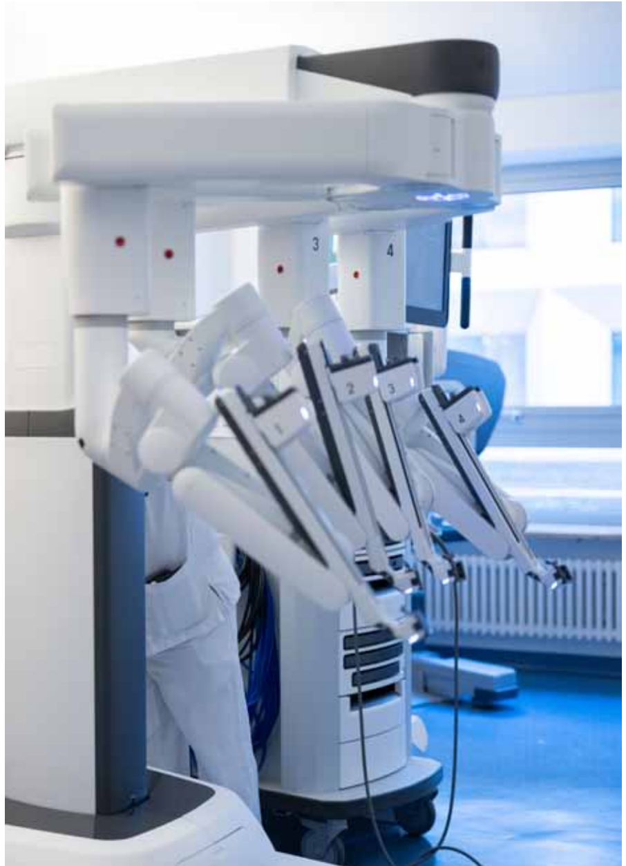
Vier Arme hat der neue Da Vinci, die sich über eine Aufhängung um die eigene Achse schwenken lassen.
